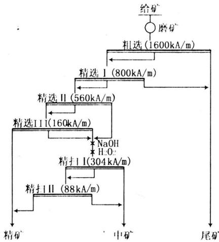
图 6 磁选—中矿碱浸出—氧化—磁选全流程
