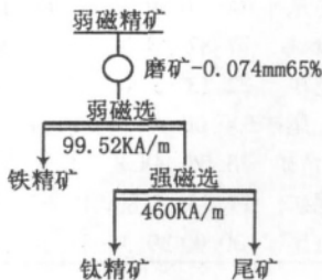
图 2 弱磁精矿铁钛分离工艺流程
