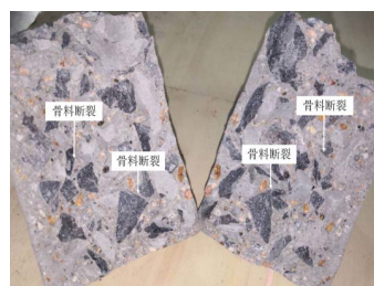
图3 C80 贫铁矿石混凝土断面
