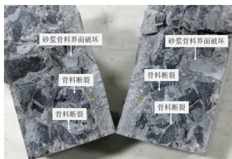
图5 C 70级基准混凝土断面
