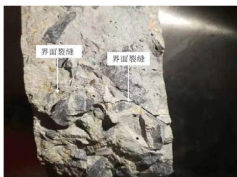
图4 C 60级贫铁矿石混凝土断面
