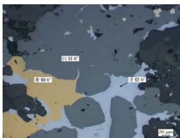
图 3 不含铜闪锌矿与黄铜矿方铅矿简单嵌布关系
